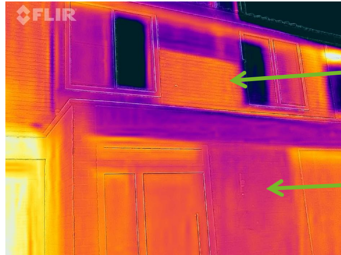
Wel een spouw maar geen spouwisolatie
