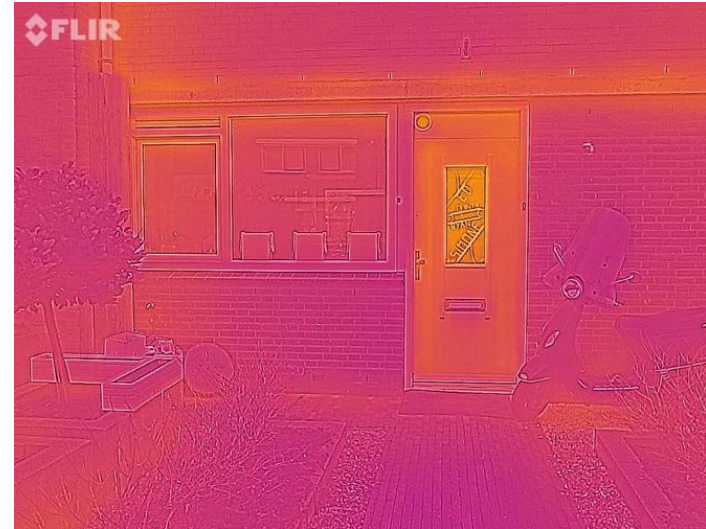
zelfde woning paar maanden later met HR++ glas, deur nog niet vervangen
