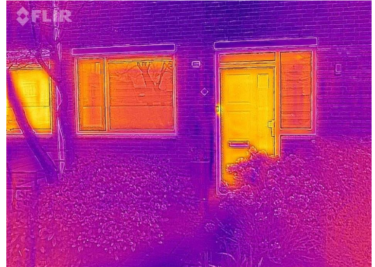
zelfde woning paar maanden later met HR++ glas, deur nog niet vervangen
